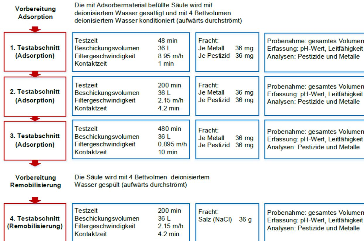
Abbildung 2: Übersicht zum Vorgehen im Labortestverfahren zur Bestimmung der Adsorption und Remobilisierung
